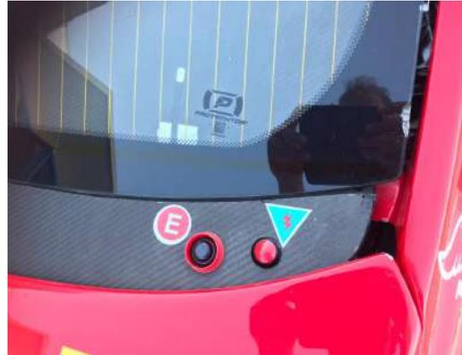
Acionamento Externo do Extintor de Incêndio e Chave Geral (lado Esquerdo)
