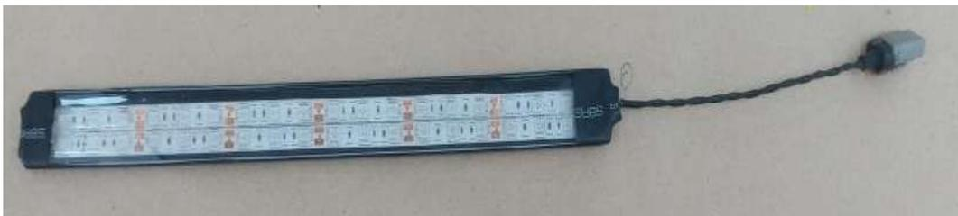
Policarbonato 300x30x4mm utilizado como base e vedação da parte da frente do LED
