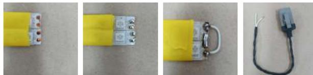
cabo AWG22 para unir o terminal positivo da fileira 1 com o terminal positivo da fileira 2, assim como com o terminal negativo. Na outra ponta da fileira foi soldado o chicote elétrico com conector 2 vias para ligação com o chicote elétrico do carro
