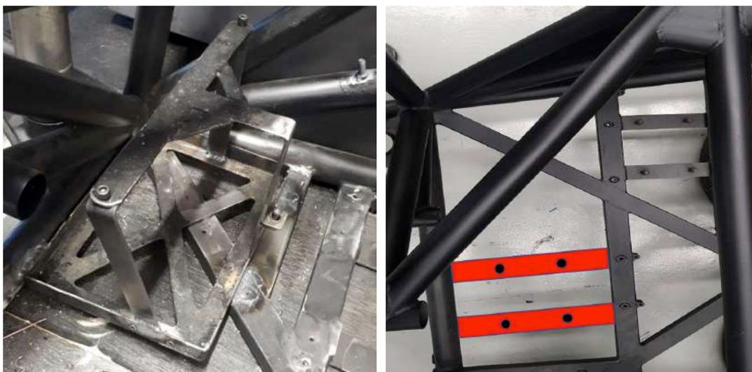
Permitido soldar travessas complementares no assoalho do chassi, exclusivamente para tornar a fixação do suporte viável. O mesmo deverá estar parafusado na estrutura tubular do chassi.
