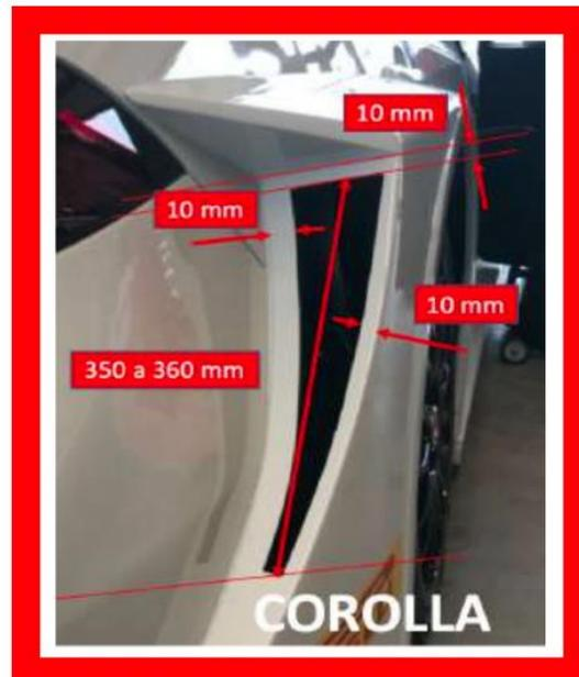
Evidenciado nas imagens acima a inexistência de qualquer espaçador entre o para-lama e o para-choque traseiro.
