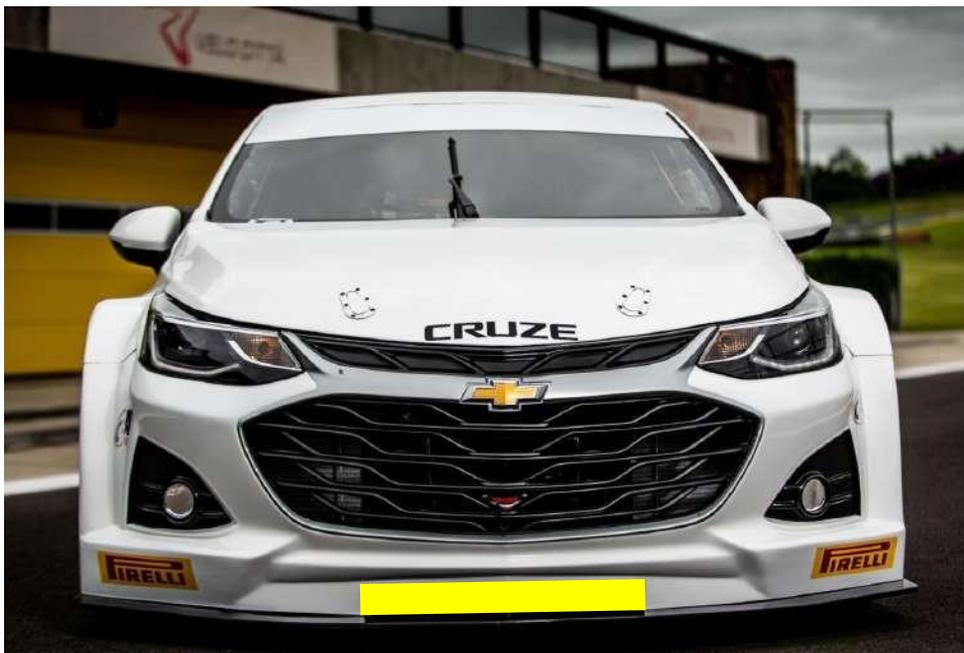
Área em amarelo, referente a abertura da entrada de ar para os dutos de freio, deverá apresentar 60mm de altura por 600 mm de comprimento, com tolerância de +/- 5 mm
