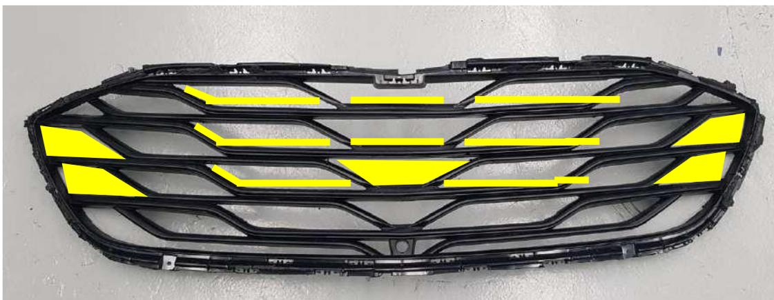
**Obrigatório remover** a segunda seção de material do perfil da grade, como indicado na imagem em amarelo. **Também obrigatório** abrir as obstruções laterais presentes na grade original.
