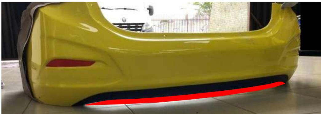
Remoção de 28 a 30 mm (**máximo**) no centro do para choque.
