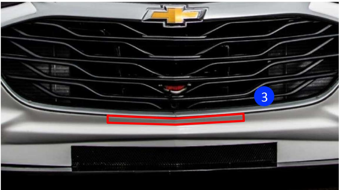
3. Permitido aumentar abertura da captação de ar conforme sugerido na imagem, seguindo o dimensional de 30 mm de altura por 400 mm comprimento.
