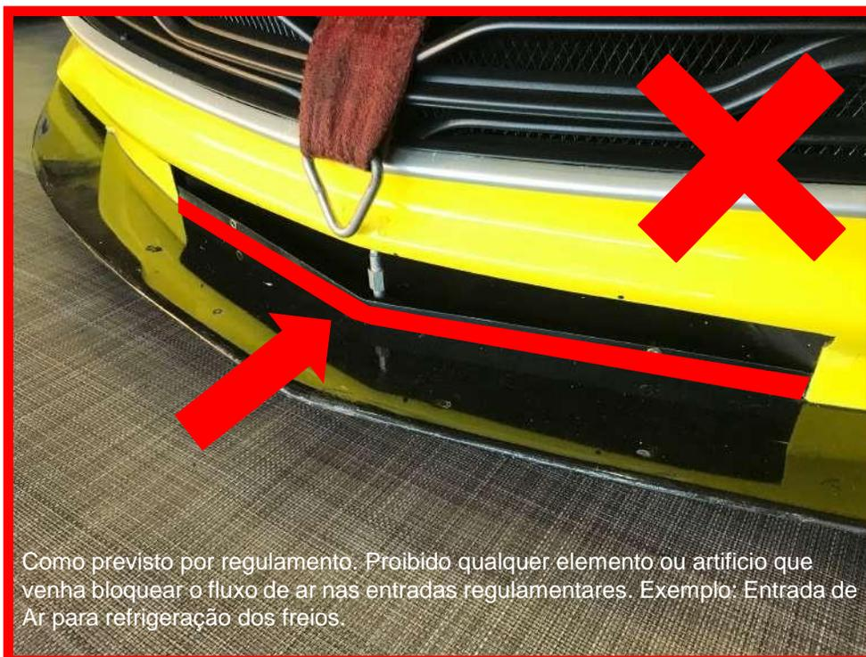
Como previsto por regulamento. Proibido qualquer elemento ou artifício que venha bloquear o fluxo de ar nas entradas regulamentares. Exemplo: Entrada de Ar para refrigeração dos freios.
