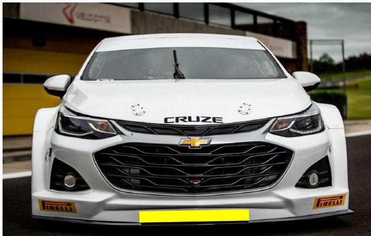
A área em amarelo, referente a abertura da entrada de ar para os dutos de freio, deverá apresentar 60mm de altura por 600 mm de comprimento, com tolerância de +/- 5 mm (**Obrigatório abertura com estas dimensões**)
